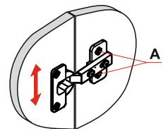
**Б) Регулирование глубины**
