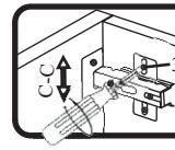
Если створка наклонена вправо или влево относительно вертикали корпуса, нужно выпрямить наклон створки в направлении А-А винтом 2.
