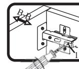
Если нижняя или верхняя часть створки отстает от корпуса, нужно ослабить винт 1 и сдвинуть створку в направлении В-В, а затем затянуть винт 1.
